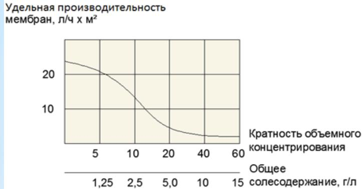
Снижение удельной производительности мембран при конц. воды с общим солесодержанием: а) 150 мг/л; б) 450 мг/л
